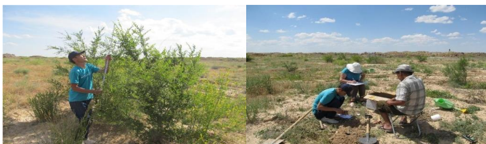
а. Үйіндідегі фитомелиоранттардың өсу б. Үйінді топырақгрунттарынан топырақ динамикасын анықтау талдауларына үлгілер алу
